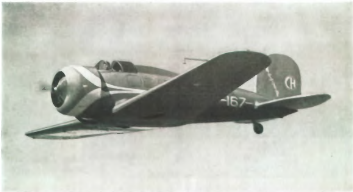
Schnell-Verkehrsflugzeug Lockheed-Orion 5-B der «Swissair». Motor Wright-Cyclone 575 PS. (Mit einziehbarem Fahrgestell.)
